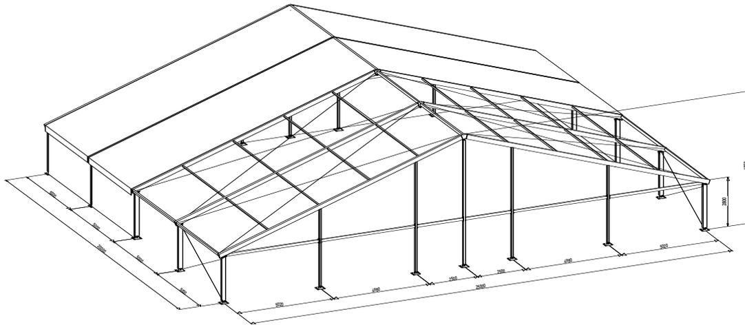
Zeltgerüst aus eloxierten, stranggepressten Aluprofilen.
